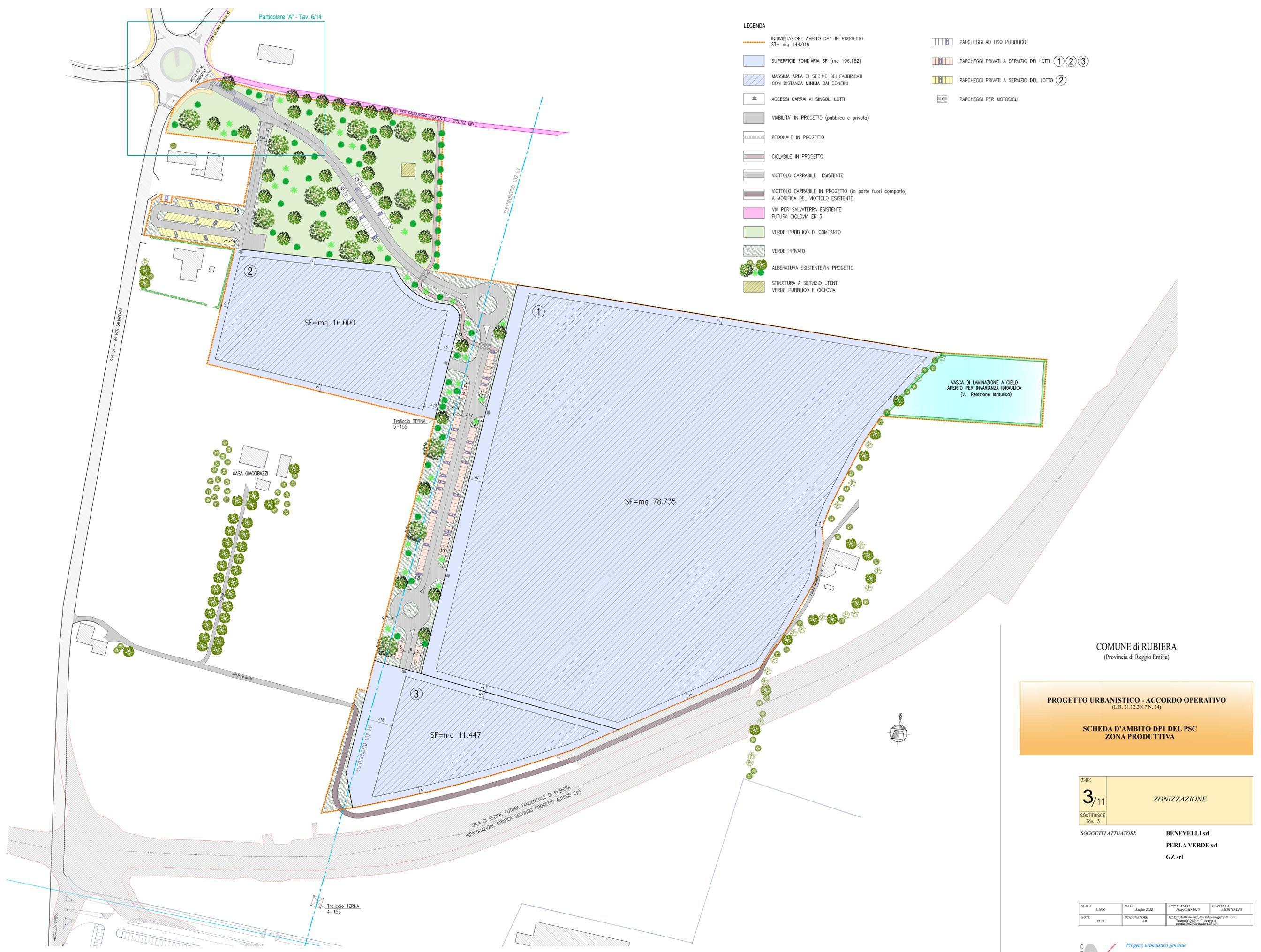
VASCA DI LAMINAZIONE A CIELO APERTO PER INVARIANZA IDRAULICA (V. Relazione Idraulica)
